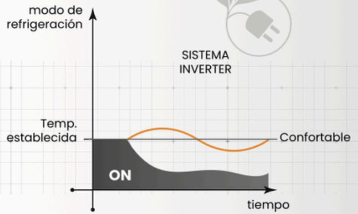
A diferencia de los compresores tradicionales que cortan y arrancan, la tecnología Inverter posee un compresor que varía su velocidad según las necesidades del ambiente y la temperatura seleccionada.
